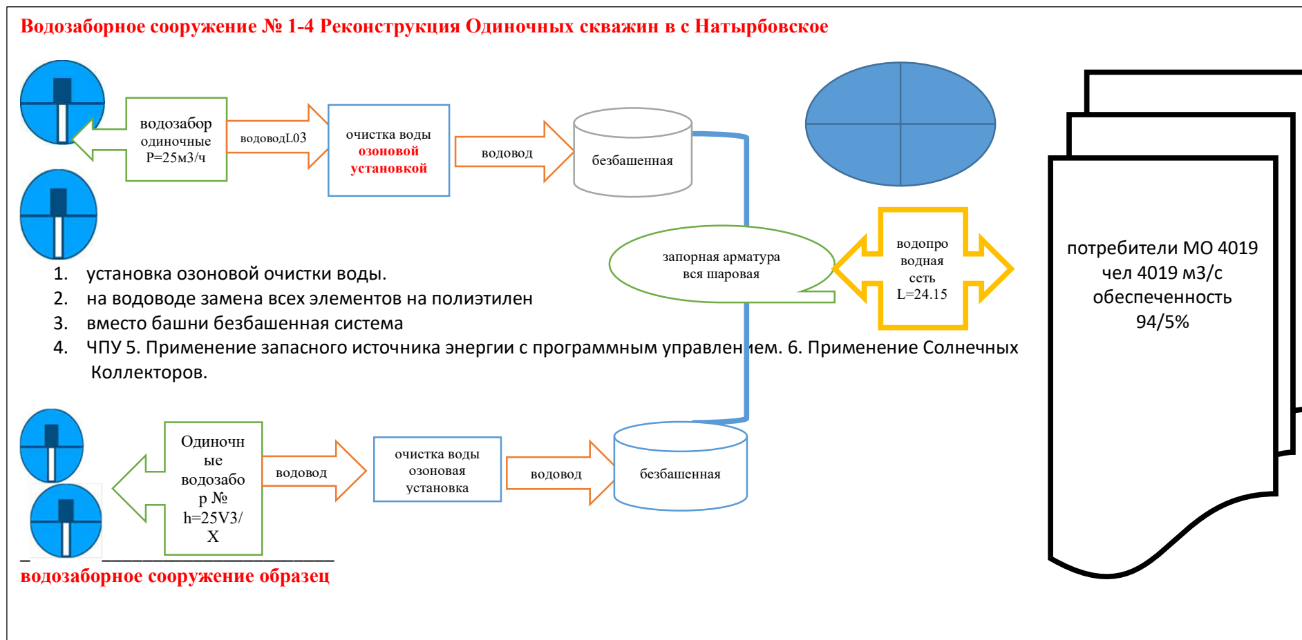
Реконструированная схема водоснабжения муниципального образования «Натырбовское сельское поселение»
